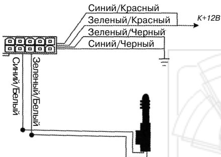
Схема 6. Установка дополнительных электродвигателей
